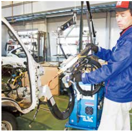
◀新型モデルの車に使われている高張力鋼板を高加圧・高電流で溶接するスポット溶接機。
